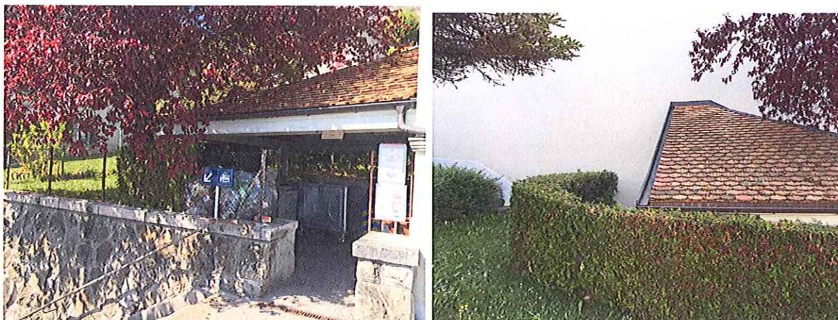
Le local existant sera agrandi de 4.80 m. le long du bâtiment communal, soit jusqu'au muret. Un mur de soutènement sera créé et l'escalier existant déplacé. L'avant-toit sera prolongé jusqu'à cet endroit.
